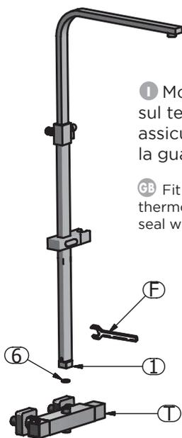
1 Montare il tubo (1) sul termostatico (T) assicurando la tenuta con la guarnizione (6).
